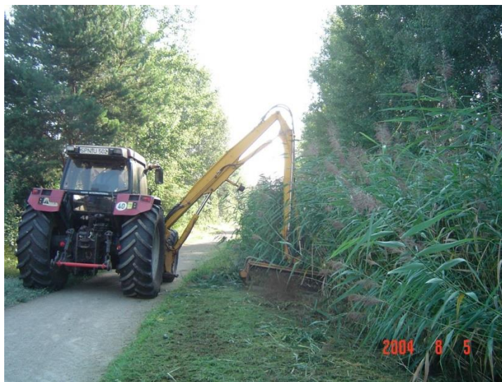
Abbildung 1: Böschungsmahd mit Schlegelmähhauser
