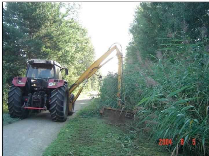
Abbildung 1: Böschungsmahd mit Schlegelmähausleger
