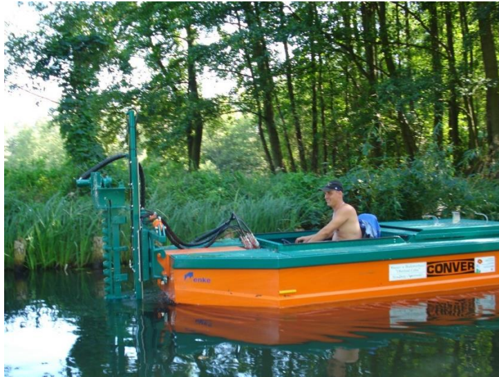
Abbildung 5: Krautmähboot mit T-Mähwerk
