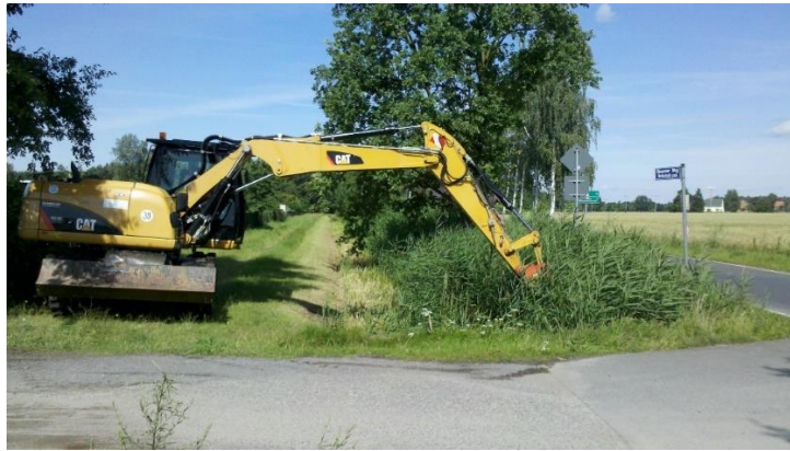
Abbildung 2: Mähkorbeinsatz mit Mobilbagger
