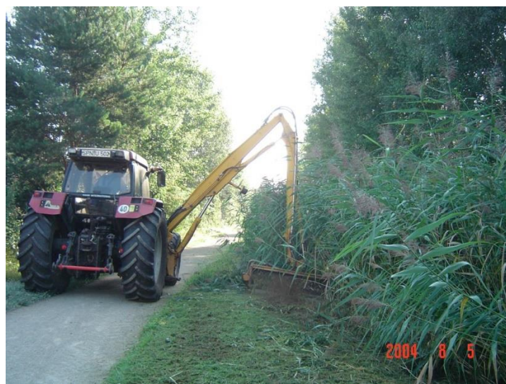
Abbildung 1: Böschungsmahd mit Schlegelmähauseleger
