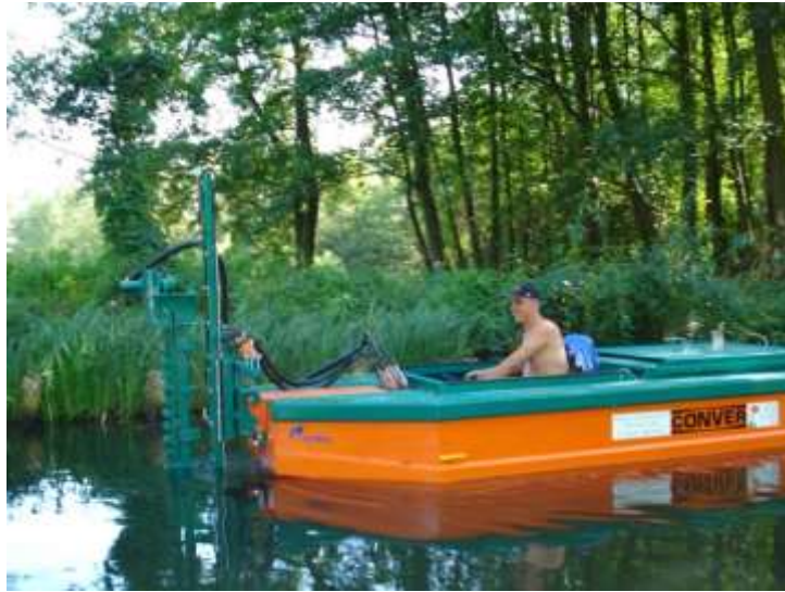
Abbildung 5: Krautmähboot mit T-Mähwerk
