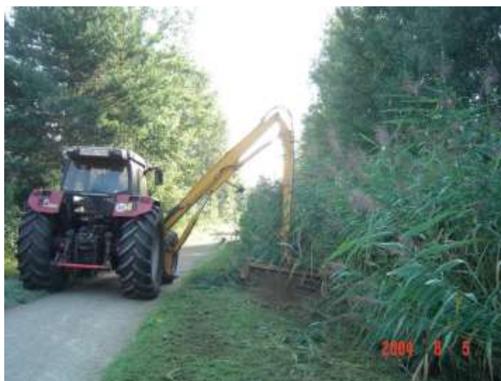
Abbildung 1: Böschungsmahd mit Schlegelmähausleger
